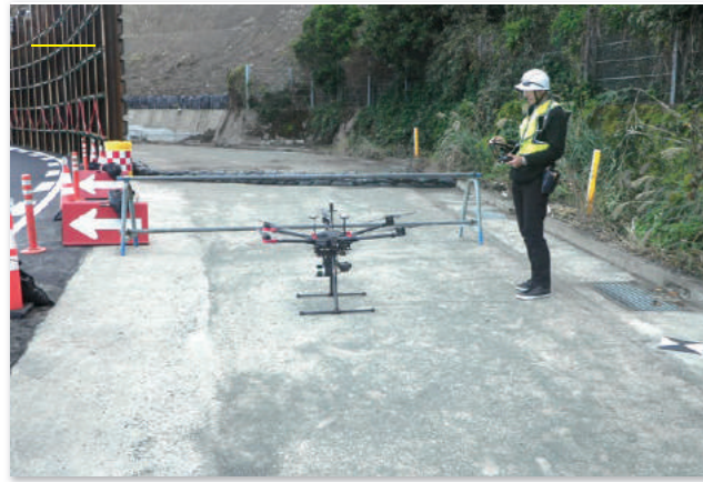
国道 220 号宮浦地区応急復旧測量業務 (ドローンによる 3D 測量)
